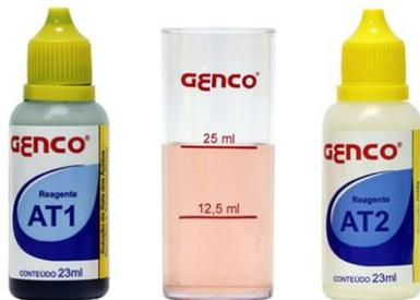
Conforme a imagem ao lado, o método mais comum para realizar o teste de alcalinidade total é utilizando o kit de teste que contém um tubo transparente e 02 reagentes (AT1 e AT2).
