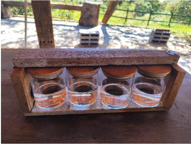
IMAGEM 01 – Exemplo de jar test artesanal.
